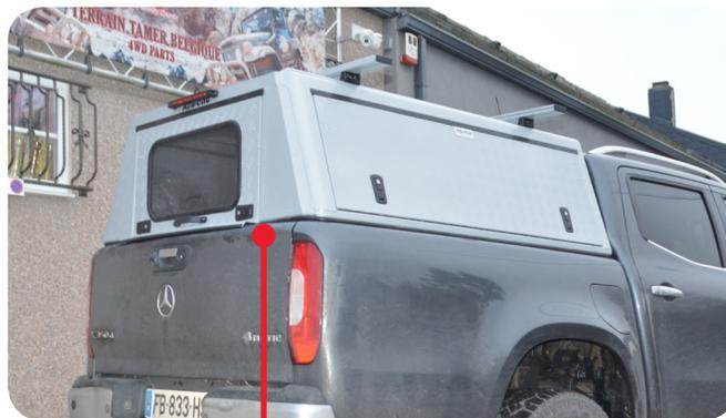
Porte de 90 cm à l'arrière, permettant le montage d'accessoires sur les côtés.
