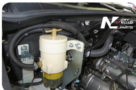
SCM0148 - Permet l'installation d'un pré-filtre FG500
